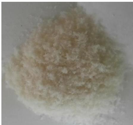
*Ilustración 70 Polvo de microcápsulas secadas por liofilización.*
