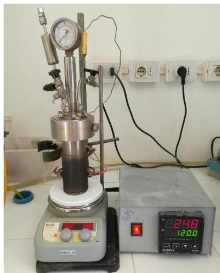
Figura 11. Reactor Semi Batch tipo Parr, con pre-cámara de inyección de reactantes y controlador de temperatura digital. Fuente: Elaboración Propia.
