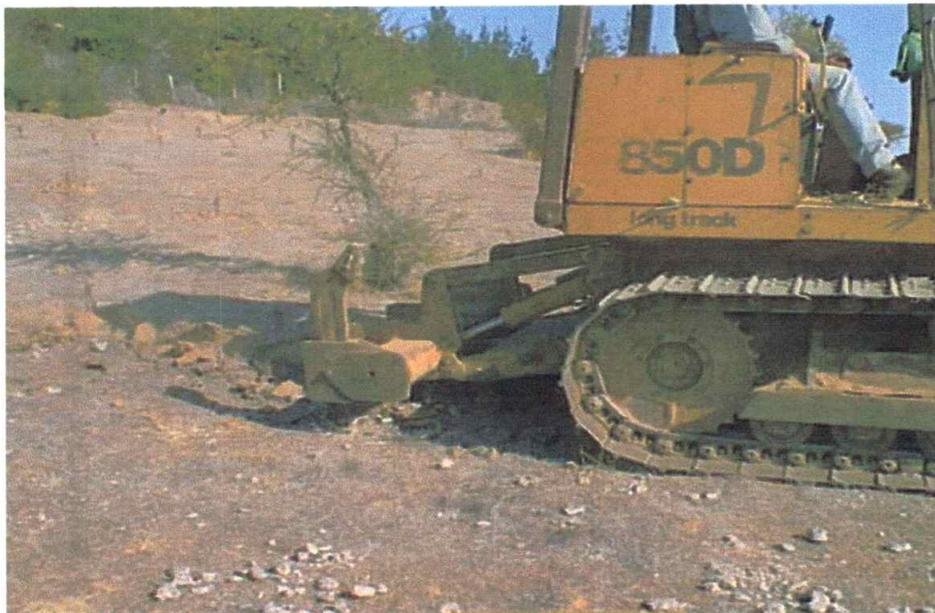
Figura 2. Bulldozer Case 850-D en faena de subsolado.
