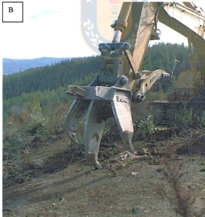
Figura 5. A) Máquina excavadora realizando la casilla de plantación. B) Accesorio utilizado consistente en una garra llamada tridente.
