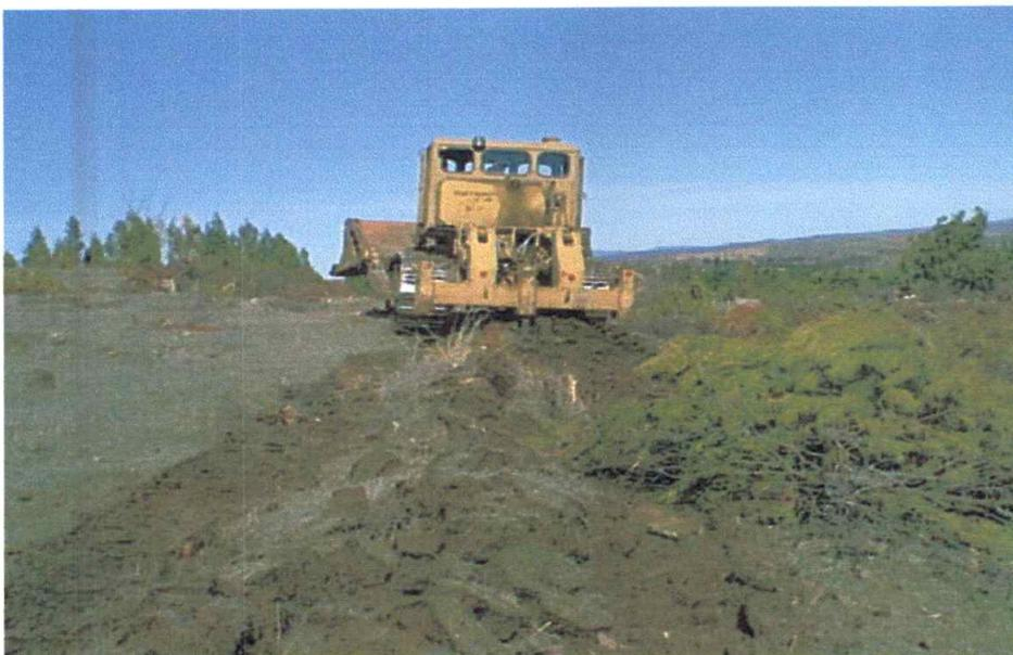
Figura 1. *Bulldozer* caterpillar D8-k en faena de subsulado.
