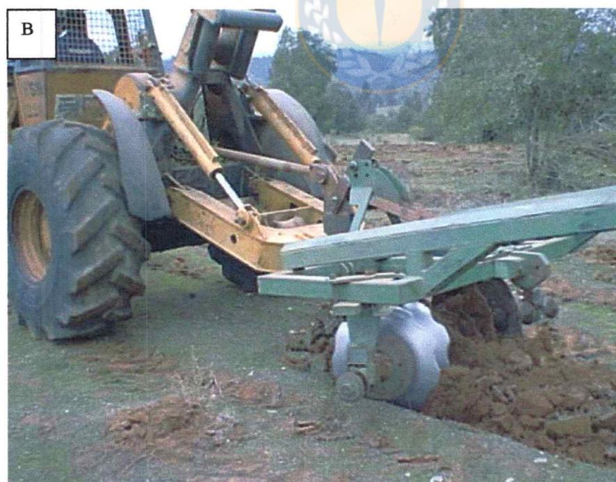
Figura 3. A) *skidder* con dispositivo de trabajo, consistente en subsolador y rastra *Savannah*. B) *Skidder* con dispositivo trabajando en faena de subsolado y rastraje.
