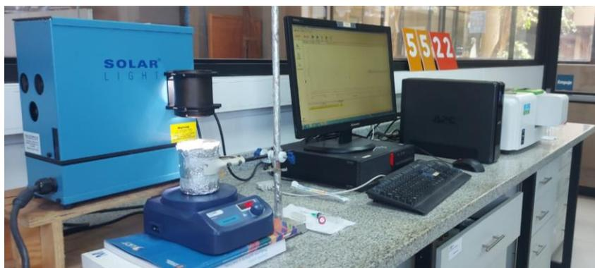
**Figura 10. Simulador solar y espectrofotómetro durante la fotodegradación.**
