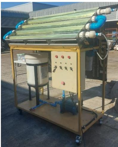
**Figura 12. Fotoreactor CPC durante la fotodegradación de Y5**
