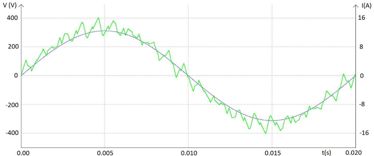
**Figura 2.5. Formas de onda de voltaje (azul) y corriente (verde) en la fase A de la red AC.**
