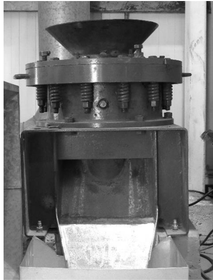
Figura 28. Chancador de planta piloto.
