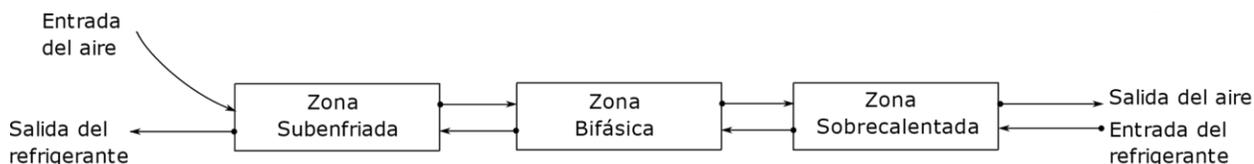
Figura 3. Modelo de tres zonas del condensador [27]
