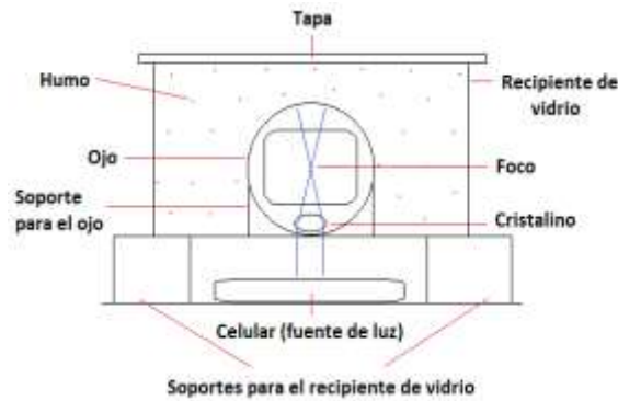
Fig. (29): Montaje para observar la refracción de la luz a través de un modelo de ojo humano.
