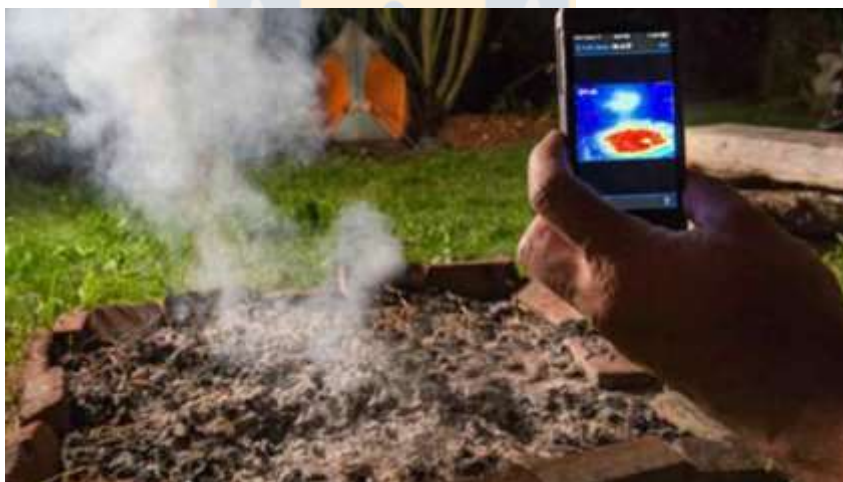
Fig. (24): Detección de radiación infrarroja mediante una app de teléfono móvil.
