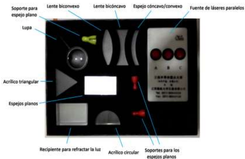
Fig. (18): Kit de Óptica con el cual introducir las leyes de la óptica. Se indican sus elementos.
