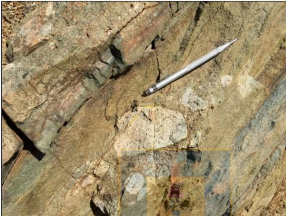
Figura 3.3: Secuencia composicional de tobas vítreas y cristalinas.
