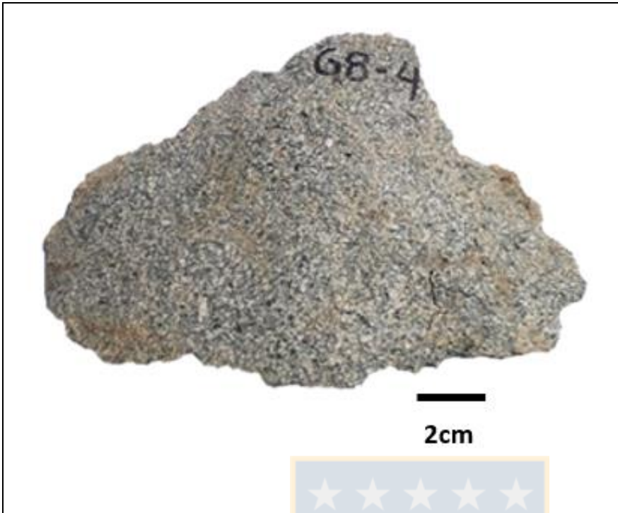
Figura 3.10: Muestra de roca intrusiva, presentando la tonalidad verdosa característica asociada a la alteración cálcica.
