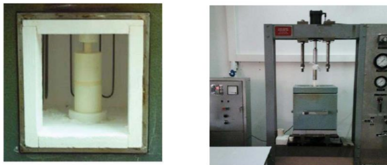
Figura 4.4. Molde de alúmina y equipo de prensado en caliente.
