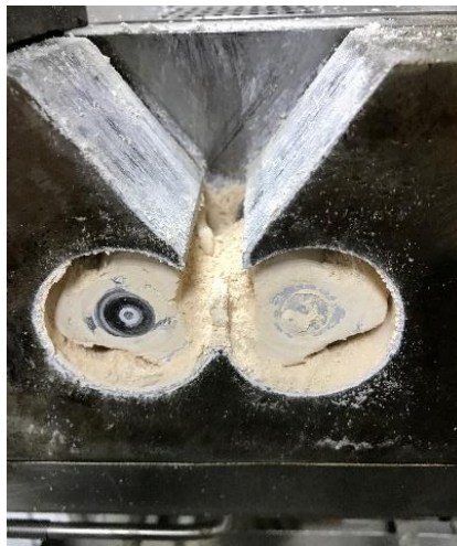
Figura 6.1. Compuesto no mezclado con x = 0.75 de carga de polvo cerámico.
