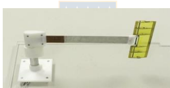
Figura 2.32. Diseño de aerogenerador piezoeléctrico [63].
