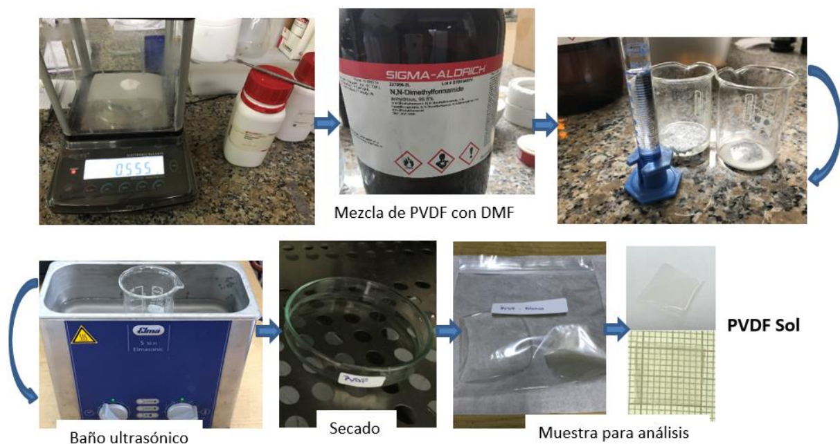
Figura 5.3. Esquema de obtención de películas delgadas por mezclado en solvente de PVDF.
