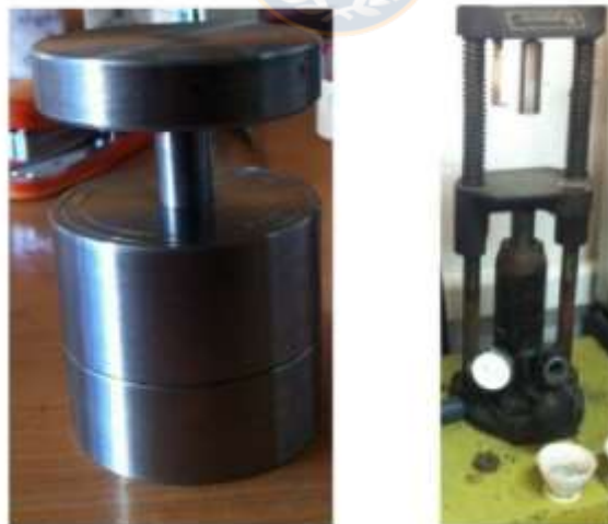
Figura 3.2 Matriz para formar pastillas y prensa uniaxial.
