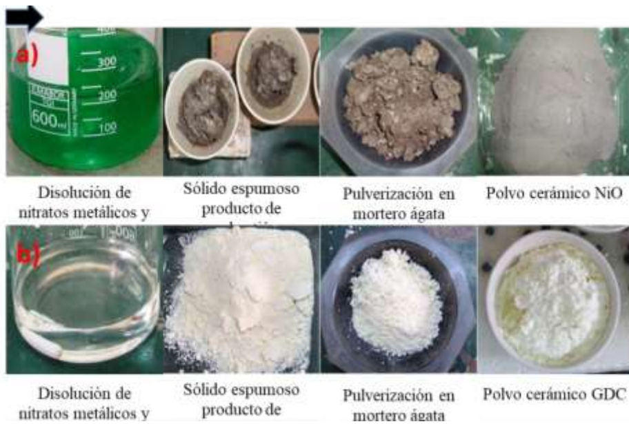
Figura 3.1 Síntesis de polvos cerámicos por solución combustión. a) NiO, b) GDC.
