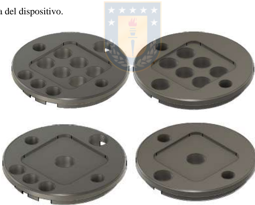
Figura 6.2. Tapas del stack para diferente número de celdas.
